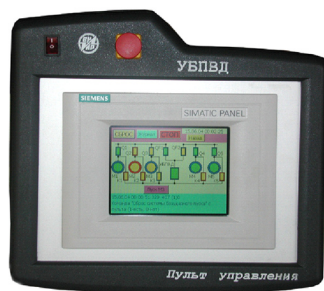
Рис. 9. Пульт управления на базе сенсорной панели оператора
